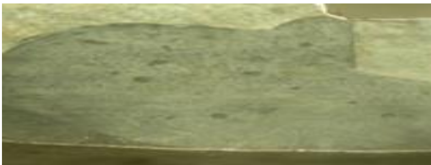
Şek. 3. AISI 304 tipi metal çiftlerinin -temel ve kaynak metalleri- benzer kaynağına ait kaynak kordonunun makroskopik görüntüsü.
