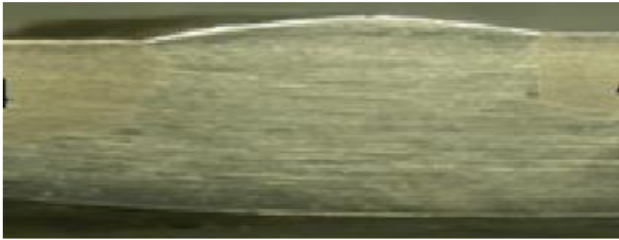
Şek. 3. AISI 304 tipi metal çiftlerinin -temel ve kaynak metalleri- benzer kaynağına ait kaynak kordonunun makroskopik görüntüsü.
