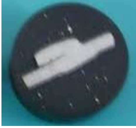
Şek. 3. Soğuk kalıplama ile hazırlanmış numune
