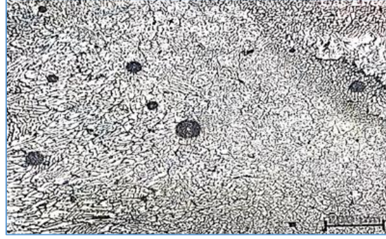
Şek. 6. Ana malzeme (solda), Heat Af (HAZ), sol köşede, kaynak bölgesi ve dolgu etkisi (ortada) ve daha fazla gözenek ve çatlak içeren yedek gaz etkisi (sağ üst köşede).
